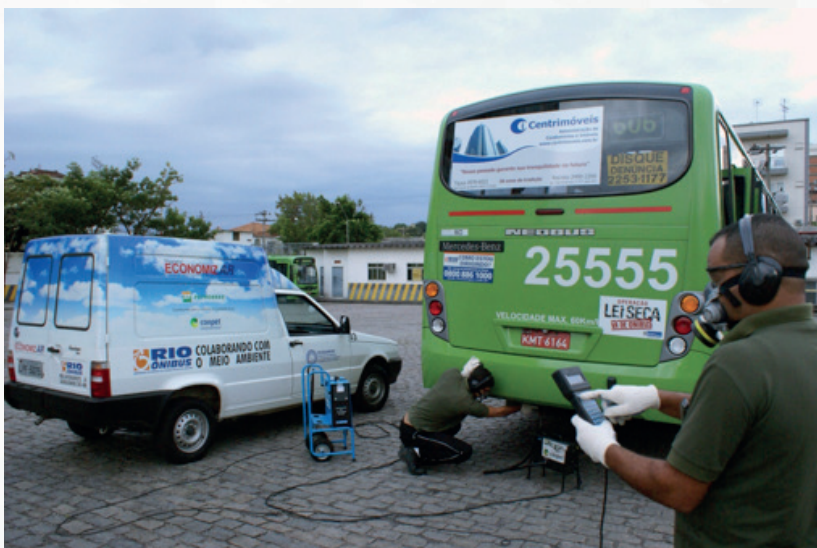
Figura 41: Ilustração do procedimento de avaliação dos níveis de emissão de fumaça pelo opacímetro
