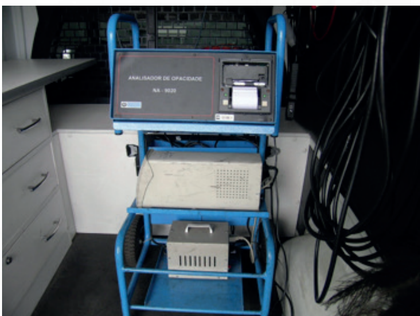
Figura 40: Opacímetro nAPRO nA-9020 utilizado para a avaliação dos níveis de opacidade da frota analisada
